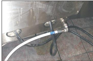
**Nota: Compruebe que la flecha en la válvula de retención apunta en la dirección de flujo del aceite usado.**
