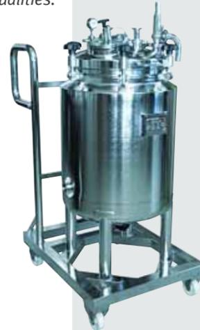
Mobiler Druckbehälter zur Herstellung von Suspensionen, Volumen 150 Liter, mit am Boden eingebautem Magnet-rührwerk, beheizbar mittels Dampf
