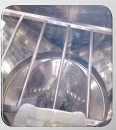
THE CHOPPER BREAKS THE LUMPS WHILE THE BOTTOM CALIBRATION GRID ASSURES THE POWDER SIZE TO BE TRANSFERRED
